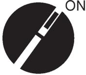
**SIEMPRE** coloque el interruptor ON/OFF en el lugar de APAGADO, quite la llave y/o desconecte el capuchón de bujía antes de dar servicio al motor o al equipo. Coloque a tierra el cable de bujía para prevenir una chispa y generar fuego.
