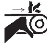
El disco está girando siempre que el motor está encendido. Eleve el disco de la superficie cuando maniobre la cortadora. El disco o la cortadora pueden sufrir daños si el disco golpea el pavimento
