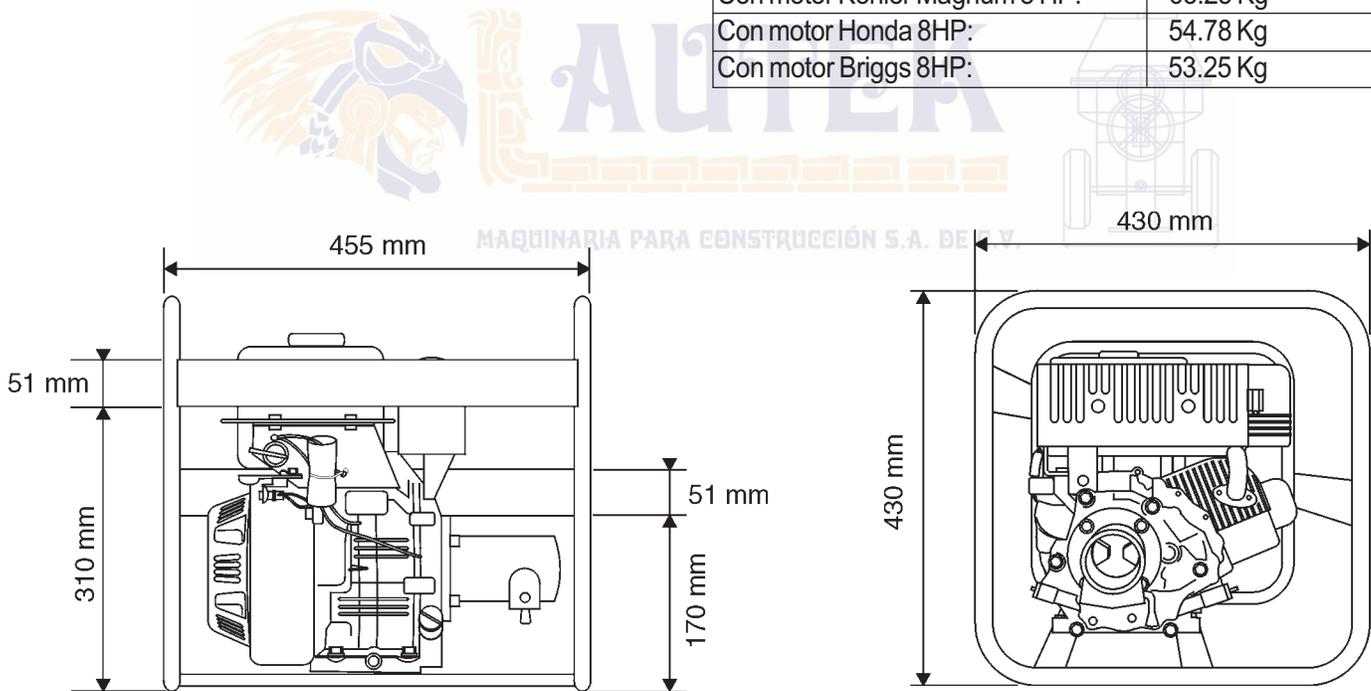
Figura 5. Unidad motriz tipo bastidor
