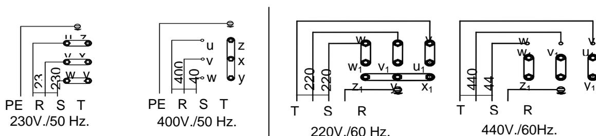
Fig. 1-2 Motor a 50 Hz. y 60 Hz.
