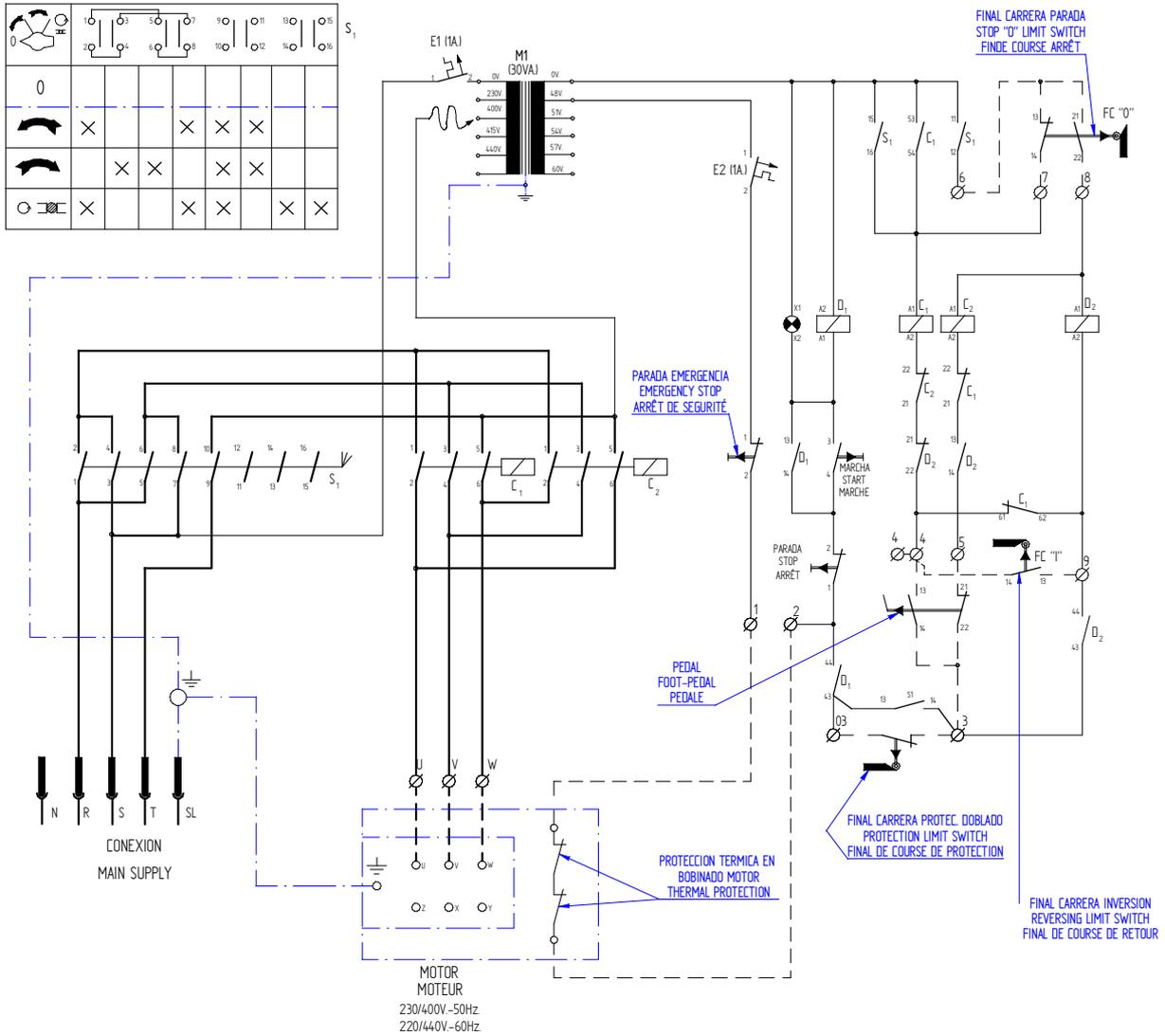
NOTA: PARA D-42L EL MICRO DE INVERSIÓN FC "I" SE MONTARÁ CON LA ROLDADA AL REVES (COTA15)
