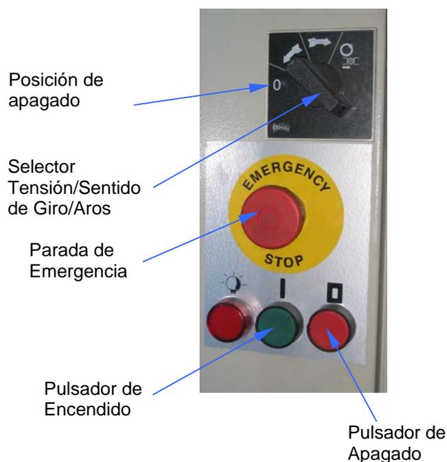
**Fig. 3-8 Apagado de la máquina**
