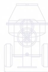
El sistema de iluminación de la torre de iluminación **CTI4500**, consiste de 4 lámparas de "Metal Halide" de 1,000 watts. Cada lámpara tiene una potencia de salida de 110,000 lúmenes produciendo un total de 440,000 lúmenes para las cuatro lámparas de alta intensidad. La cobertura de la iluminación típica es de entre 2 a 3 hectáreas.
