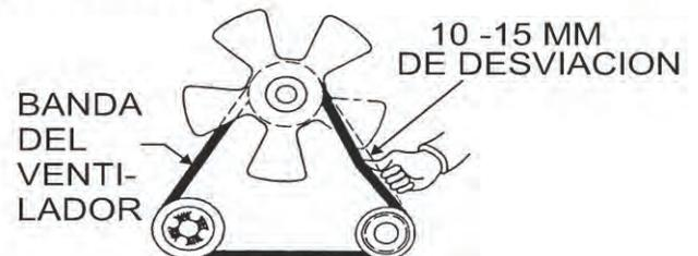
**Figura 14. Tensión de la banda del ventilador**
