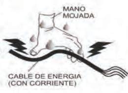
**NUNCA** toque ó agarre un cable con corriente, existe la posibilidad de **choque eléctrico, electrocución, e incluso !la muerte!**
