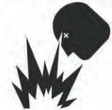
**NO** llene el tanque de combustible mientras el motor esta funcionando o caliente. **NO** llene de más el tanque, ya que al derramarse el combustible, podría encenderse si entra en contacto con partes calientes del motor ó la chispa del sistema de ignición. Almacene el combustible en recipientes apropiados, en áreas ventiladas y lejos de chispas y flamas.
