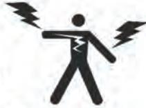
**SIEMPRE** confirme que la **CTI4500** este bien conectada a tierra y seguramente atada a una buena conexión a tierra (varilla enterrada). Existe la posibilidad de **choque eléctrico, electrocución, e incluso la muerte**, si la torre de luz no esta conectada a tierra.
