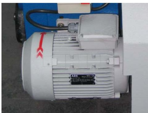
Fig. 1-5 Flecha de sentido de giro del motor
