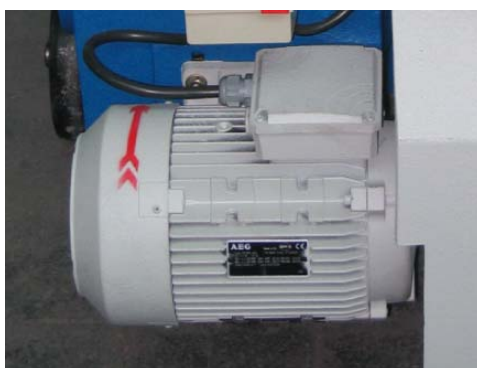
Fig. 1-5 Flecha de sentido de giro del motor
