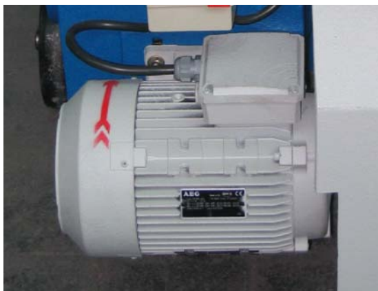
Fig. 3-3 Flecha que indica el sentido de giro del motor
